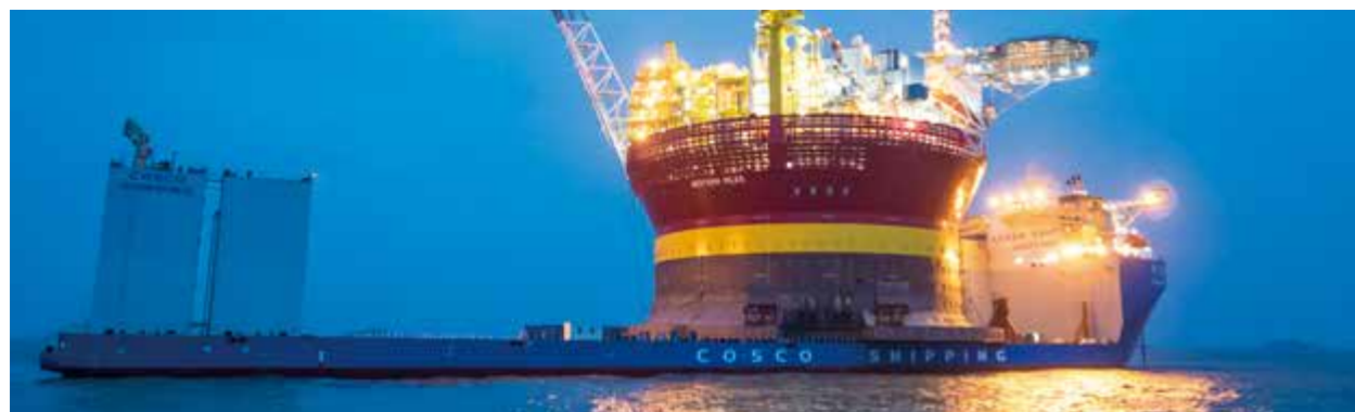
“新光华”轮半潜船是目前国内最大、全球第二大的半潜船，也是目前全球最大的具备 DP2 动态定位系统的半潜船
