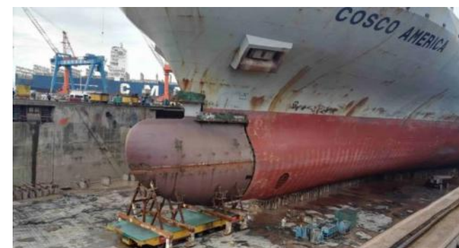
2021年集团完成68艘船舶的球鼻艏改造，改造后可减少集装箱船舶降速航行时的水阻，降低船舶航行油耗和碳排放
