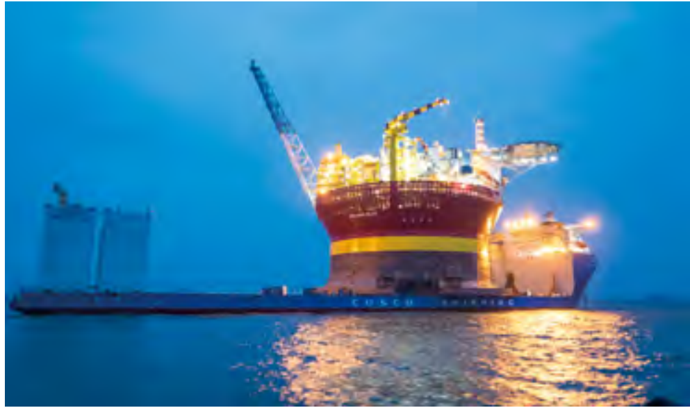
圆筒型浮式生产储卸油平台（FPSO）“希望 6 号”
