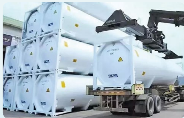
LNG 罐箱既便于堆码排列，又大幅度减轻了集装箱的非有效重量，同时保护放置在其中的低温液体贮罐的安全，在天然气全产业链各环节均具备独有优势
