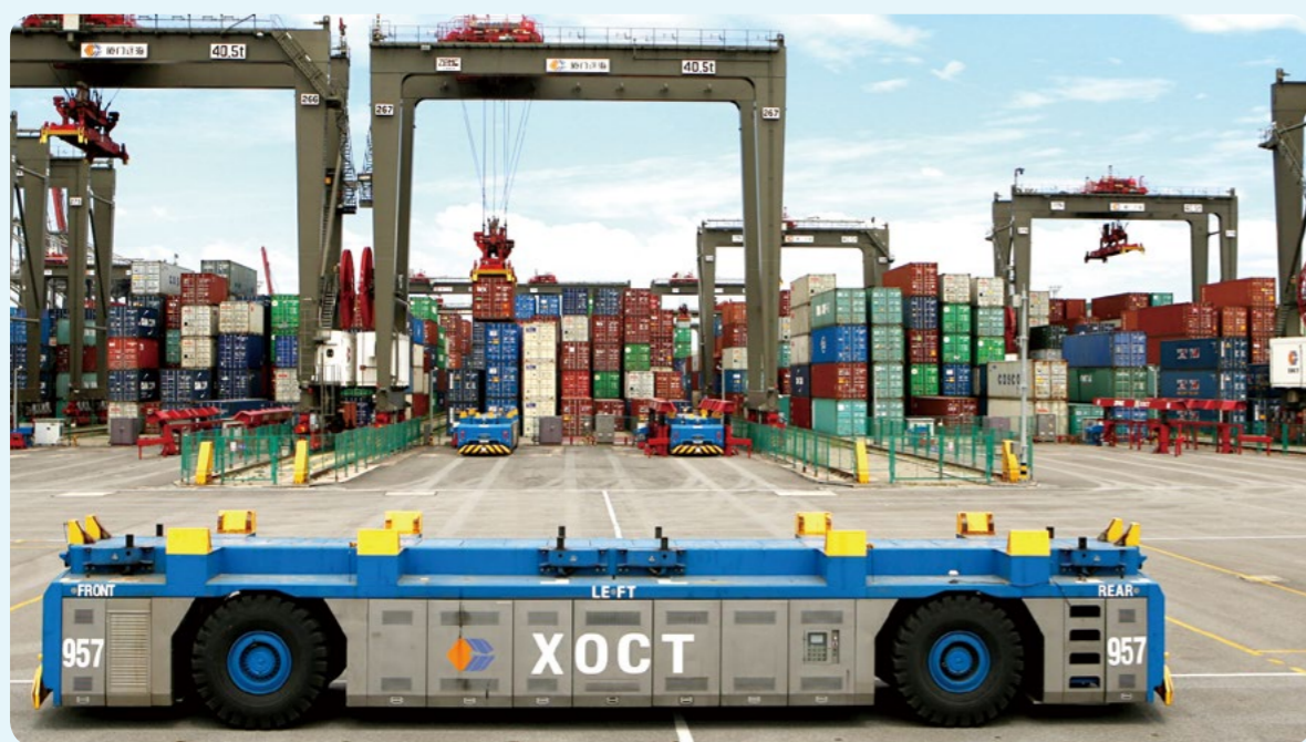
厦门远海码头上无人操作的自动引导车（Automated Guided Vehicles, AGV）
